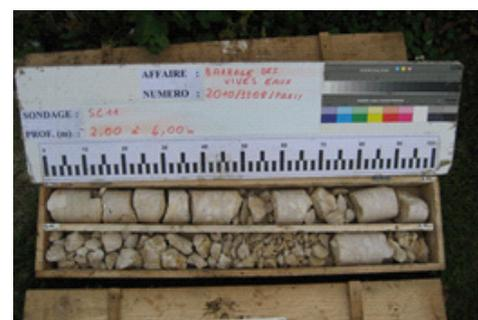
Figure 3: Caisse de carottes prélevées après un sondage sur le site de Vives-Eaux (Source : GEOTEC)
