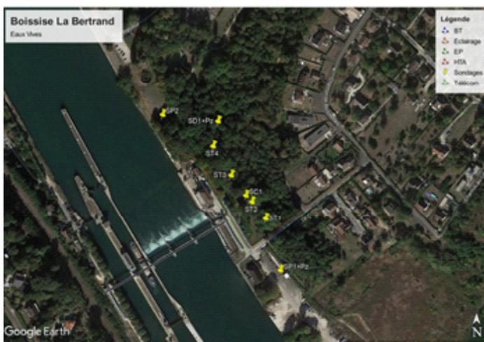
Figure 1 : Vue en plan de la localisation des futurs sondages géotechniques (Source : société BEFES).
